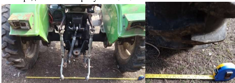
Рисунок 8 – Измерение ширины колесной колеи на задней оси
