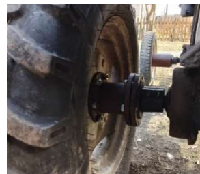
Рисунок 7 – Установленные удлинители на одной из сторон трактора
