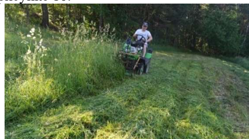
Рисунок 11 – Проведение динамических полевых испытаний на склоне
