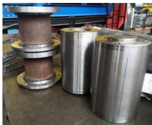
Рисунок 6 – Экспериментальные образцы ступичных удлинителей
