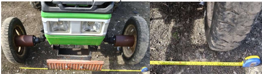
Рисунок 9 - Измерение ширины колесной колеи на передней оси
